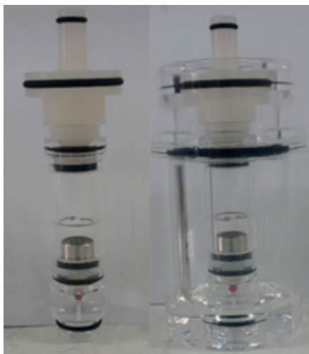
Figura 5. Propuesta de configuración de celda de polvos para aparato USP IV
